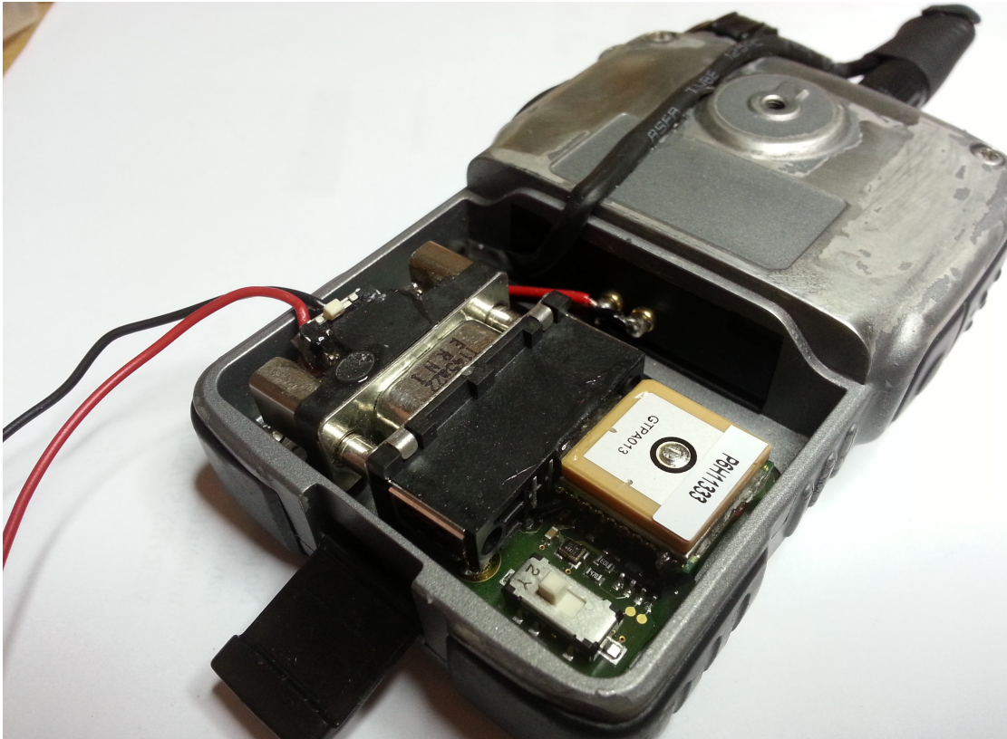
Funkgerät und Tracker werden aus einem externen Akku betrieben.
